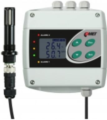
Humidistato, termostato con dos salida de relé. Sonda T+RH de duroaluminio anodizado duro para aire comprimido hasta 25 bars con 1m de cable. Longitudes de cable 2m o 4m disponibles opcionalmente. Uso interior/exterior.
