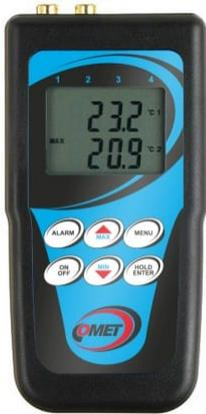
Termómetro de alta precisión para sensor Ni1000.
