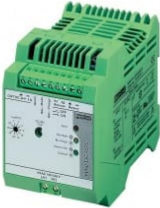
Fuente de alimentación de respaldo A6963, modelo MINI-DC-UPS/24DC/2 con batería A7963, modelo MINI-BAT/24DC/1.3AH, fabricante Phoenix Contact. Fuente de alimentación diseñada para montaje en carril DIN 35mm en el caso de los registradores de datos MP033 y MP034. Contiene dos módulos - UPS y batería. La fuente de alimentación se suministrada desinstalada en el empaquetado original del fabricante.
