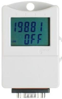
Registrador de datos diseñado para el registro de impulsos y señales de dos estados. Los valores son almacenados en memoria electrónica no volátil. La transmisión de datos al ordenador personal para su posterior análisis se realiza mediante USB, RS232, GSM o interfaz Ethernet por medio de un adaptador adecuado.
